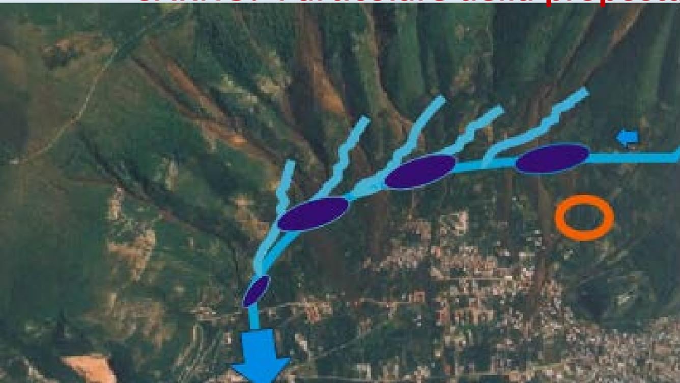
**SARNO: Particolare della proposta alternativa. In sintesi un grande invaso in terra lungo tutto il piede del versante in grado da raccogliere le prossime colate di fango, da utilizzare come terreno agricolo nel tempo e da svuotare quando pieno, portando il terreno fertilissimo in aree dove necessita**
